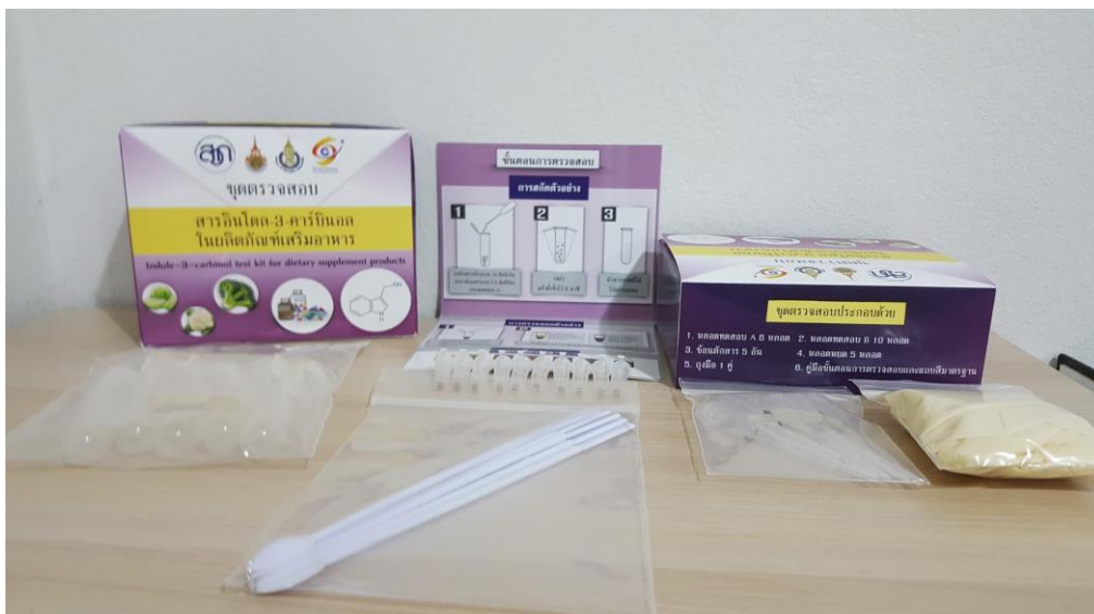
ภาพที่ 13 แสดงต้นแบบ (Prototype) ชุดทดสอบสาร indole-3-carbinol ในตัวอย่างผลิตภัณฑ์เสริมอาหาร สำหรับการจำหน่ายในเชิงพาณิชย์
