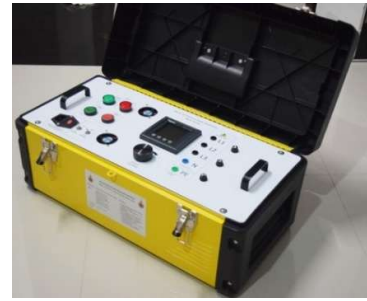
รูปที่ 4 ชุดทดสอบโปรเทคชั่นรีเลย์ที่ประกอบเสร็จสมบูรณ์
