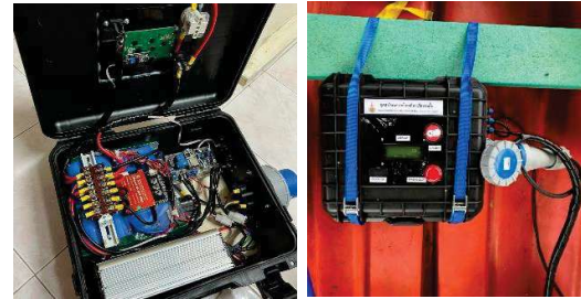
รูปที่ 6 ชุดควบคุมและแสดงผลที่ลงกล่องเสร็จสมบูรณ์
