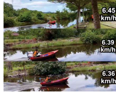
รูปที่ 10 ทดสอบการขับเคลื่อนเรือไฟเบอร์กลาส ขนาด 8 ฟุต
