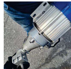
รูปที่ 2 ใบจักรเรือหางสั้นที่นำมาดัดแปลงประกอบกับมอเตอร์
