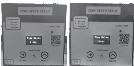
รูปที่ 11 การตั้งเวลาหน่วง 5 และ 20 วินาที ก่อนการสั่งทริปของรีเลย์
