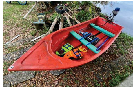
รูปที่ 7 ชุดขับเคลื่อนเรือไฟฟ้าหางสั้นที่ติดตั้งบนเรือไฟเบอร์กลาส 8 ฟุต
