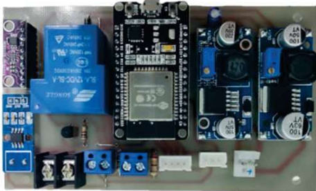
รูปที่ 5 บอร์ดควบคุมและแสดงผลที่ประกอบแล้วเสร็จ
