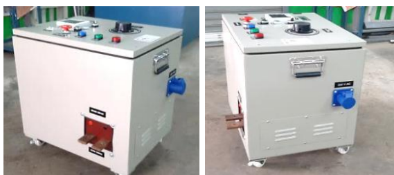
รูปที่ 6 ชุดทดสอบเซอร์กิตเบรกเกอร์ที่ประกอบเสร็จสมบูรณ์
