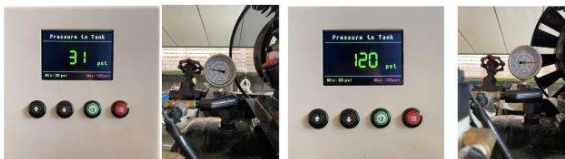
รูปที่ 8 ค่าความดันเริ่มทำงานและหยุดทำงานของปั๊มลม
