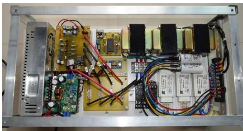
รูปที่ 3 การประกอบและเดินสายภายในโครงอลูมิเนียม
