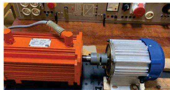
รูปที่ 8 การทดสอบขับโหลดของมอเตอร์ไร้แปรงถ่าน
